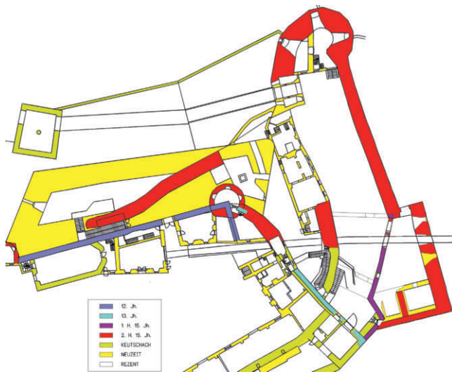
Hohensalzburg, Baualtersplan des östlichen Torwegs (mit Höhengsprüngen)
