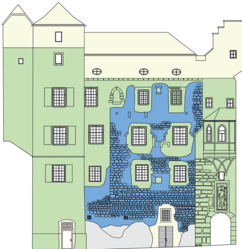
Festung Hohensalzburg, Baualtersplan der Ostfassade des Hohen Stocks. In blau ist der romanische Kernbau mit den Ansätzen der dortigen Triforen zu erkennen. In grün sind gotische Ausbauten des 14. und 15. Jahrhunderts zusammengefasst, in gelb barocke Adaptierungen
