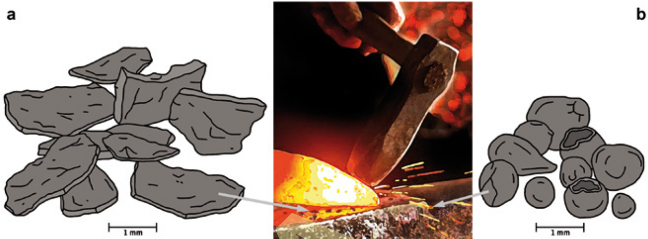
Abb. 88 Idealisierte Darstellung der Entstehung von schuppigem (a) und kugeligem (b) Hammerschlag während des Schmiedeprozesses.
