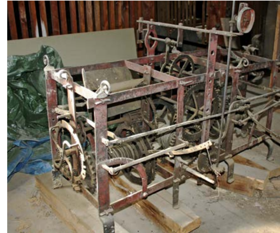
Das Turmuhrwerk von Schloss Hornegg in Preding, Steiermark, hier vor der Restaurierung und Revitalisierung 2020/2021: Es stammt im Kern aus dem 17. Jahrhundert. © horologium
