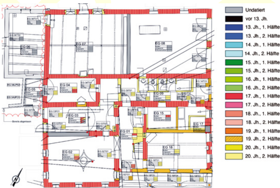
Abb. 2 Heuberg I, Braugasthof. Baualterplan des Erdgeschoßes.
