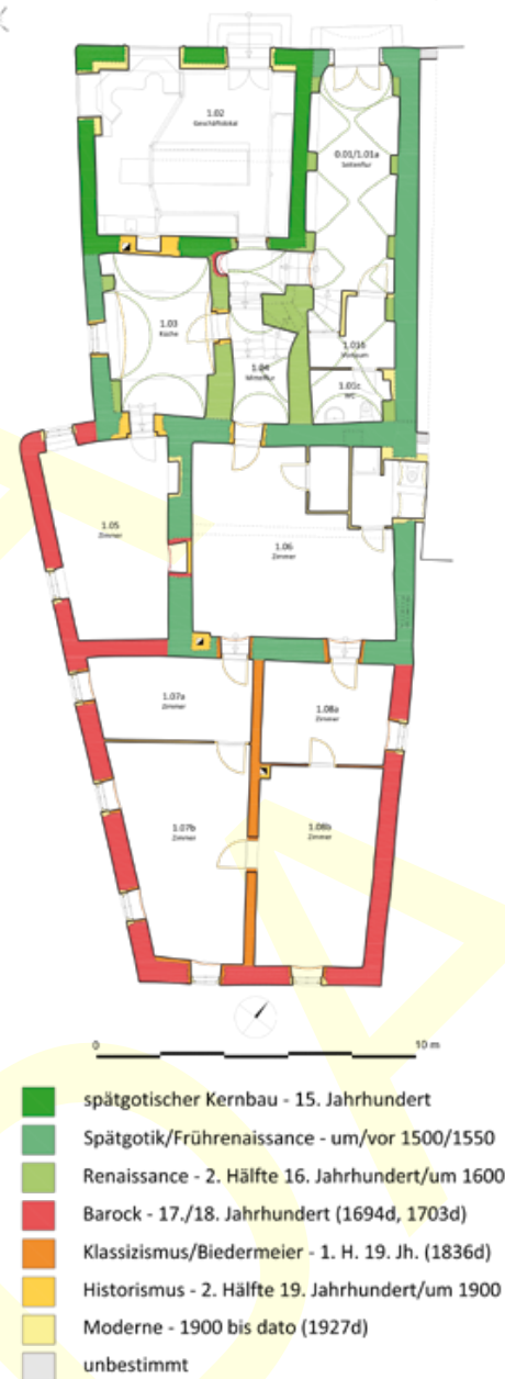
Abb. 3 Emmersdorf, Bürgerhaus. Baualterplan des Erdgeschoßes.
