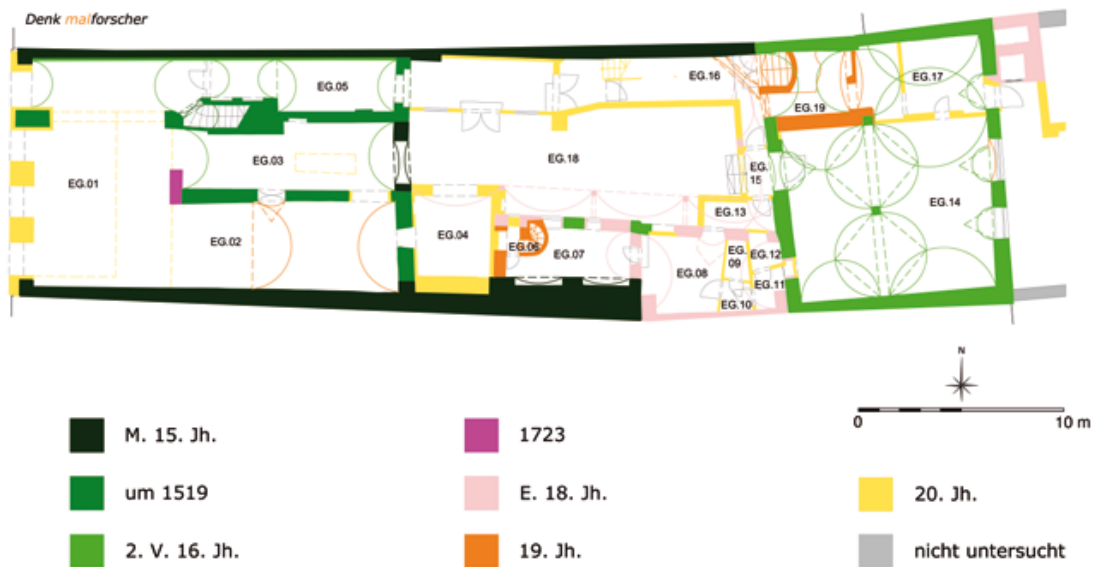
Abb. 1 Braunau am Inn, Bürgerhaus. Baualterplan des Erdgeschoßes.
