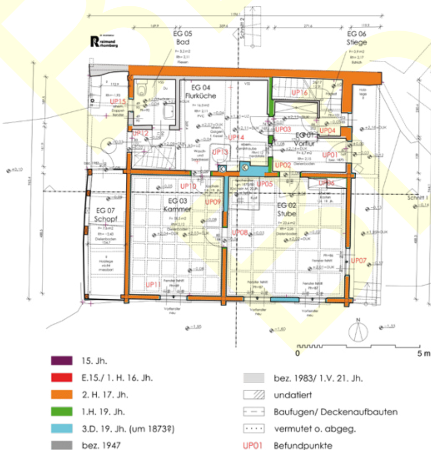
Abb. 1 Blons, Bauernhaus. Baualterplan des Erdgeschoßes.
