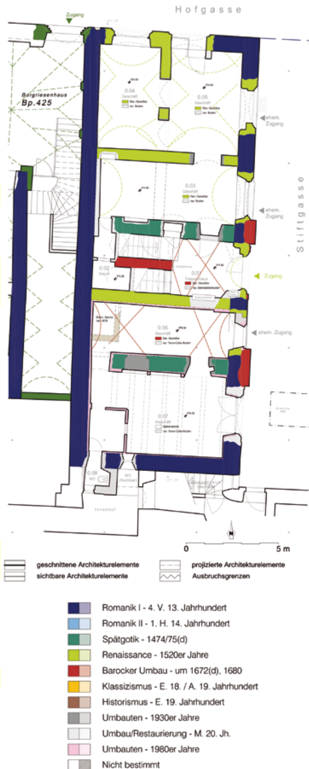
Abb. 5 Innsbruck, Kleines Riesenhaus. Baualterplan des Erdgeschoßes.
