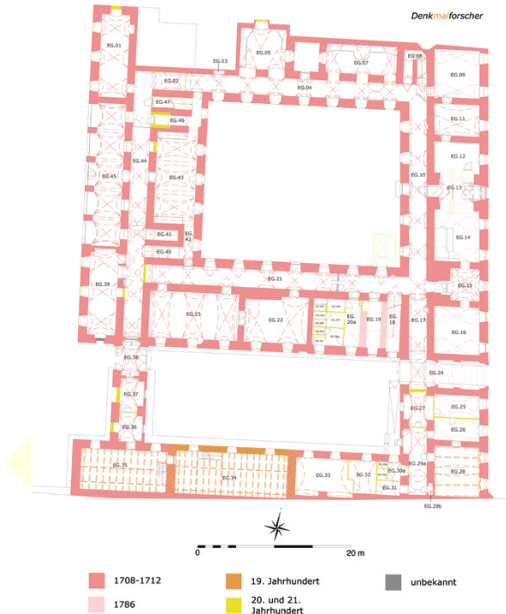
Abb. 25 St. Pölten, ehemaliges Karmelitinnenkloster. Baualterplan des Erdgeschoßes.
