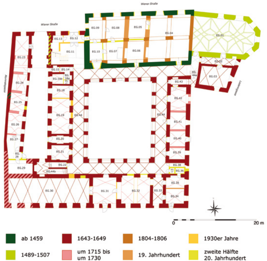
Abb. 26 St. Pölten, Bischöfliches Alumnat. Baualterplan des Erdgeschoßes.
