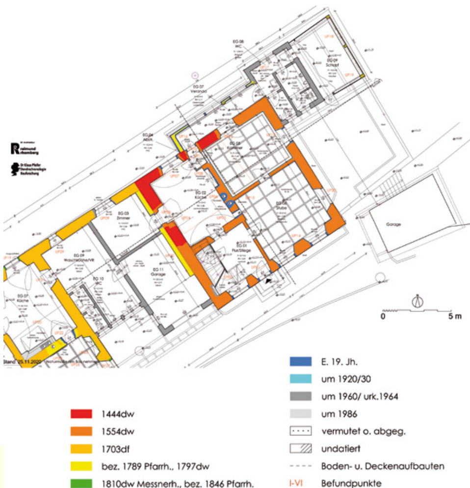
Abb. 5 Rankweil, Mesnerhaus. Bualterplan des Erdgeschoßes.
