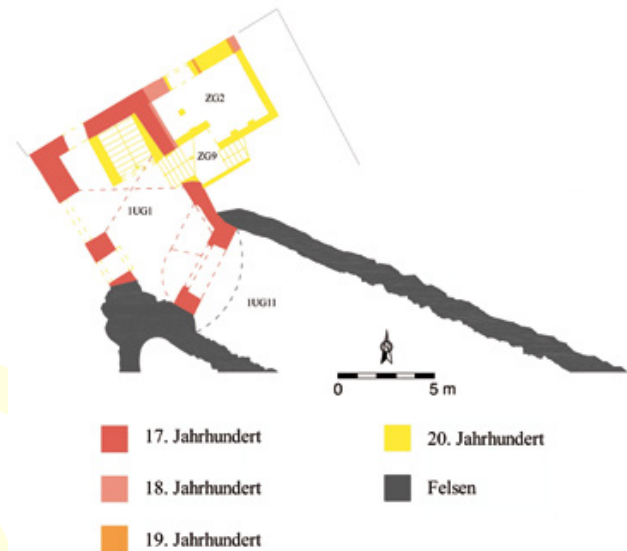
Abb. 33 Unterloiben, Dinstlgut. Baualterplan des 1. Untergeschoßes.
