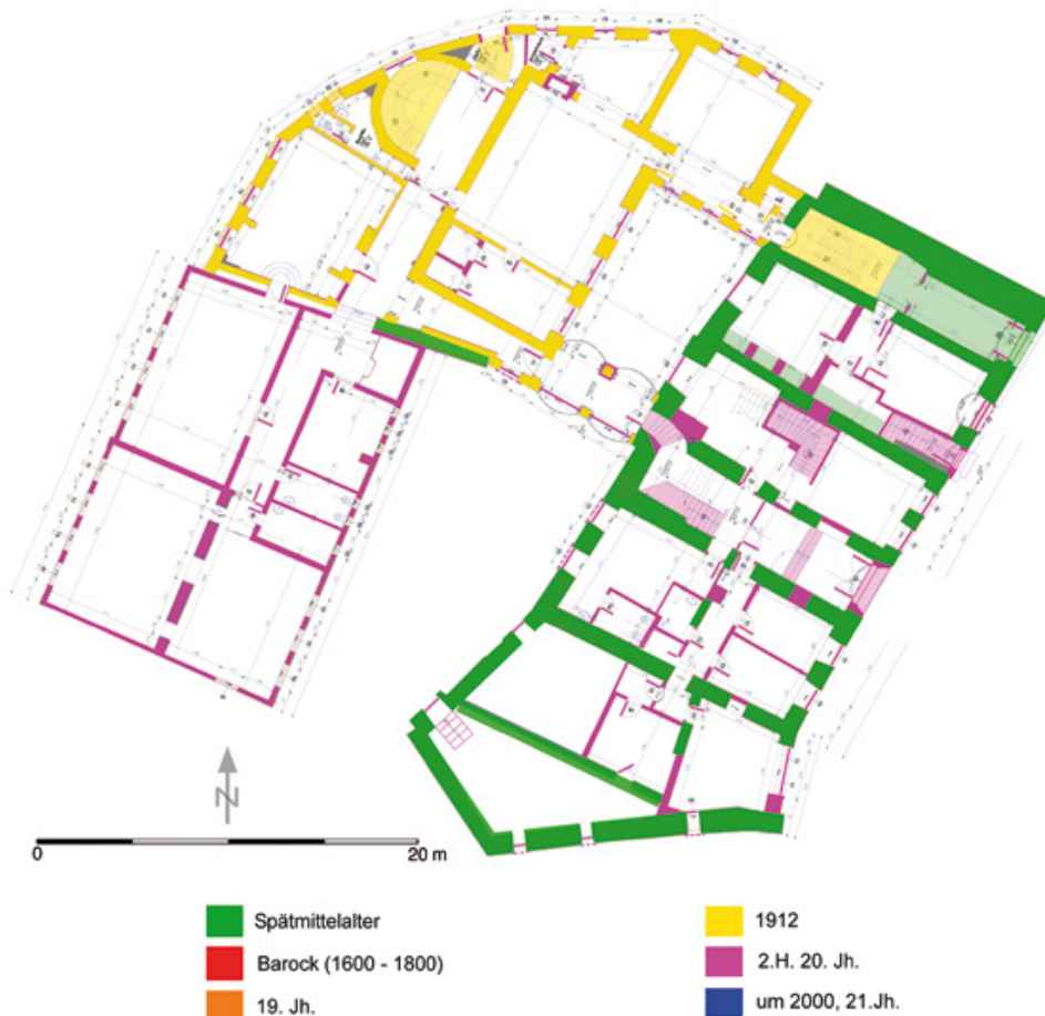
Abb. 1 Hallein, Bürgerhaus. Baualterplan des Erdgeschoßes.
