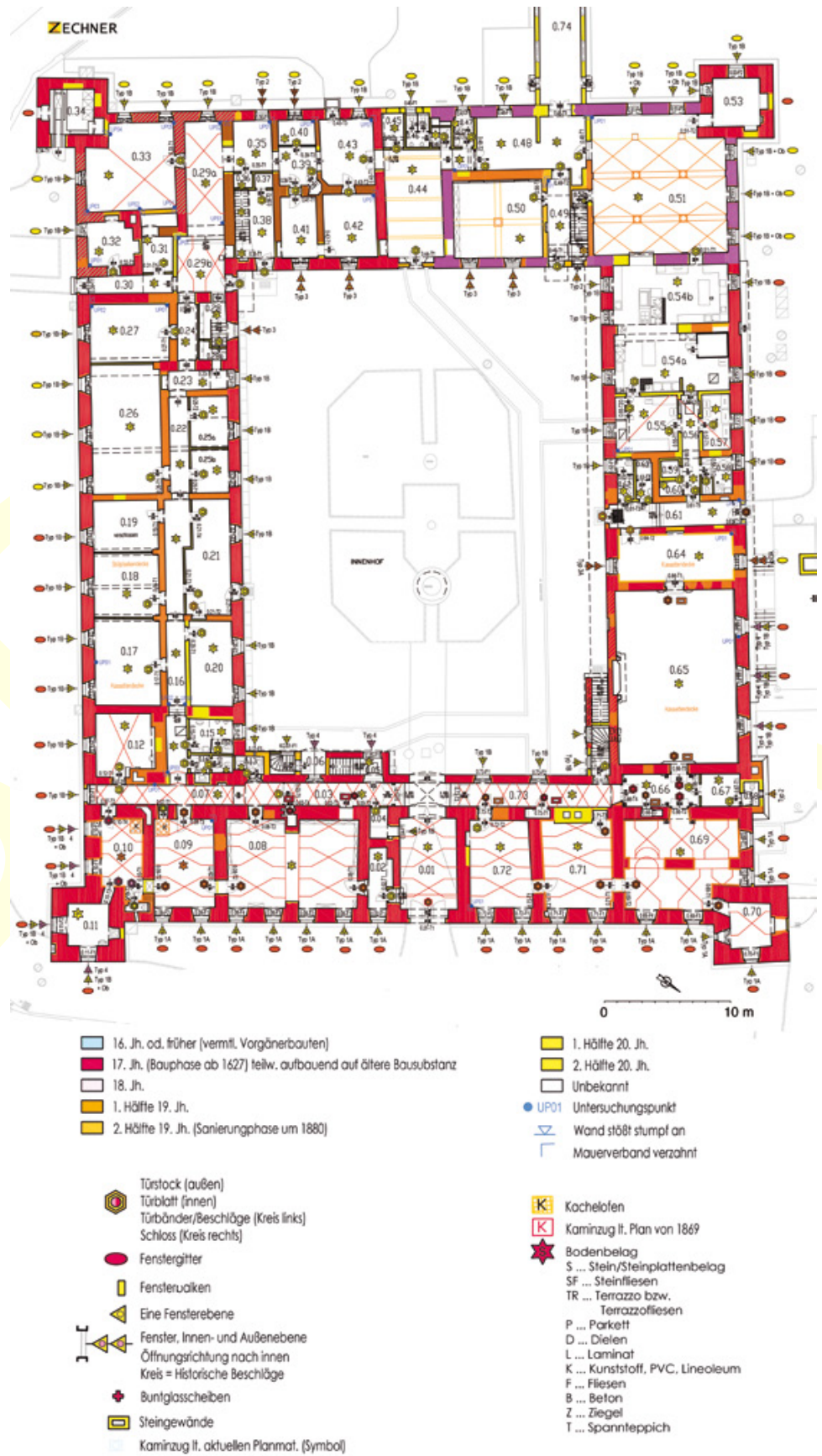
Abb. 5 Ort-Gmunden, Landschloss Ort. Baualterplan des Erdgeschoßes.
