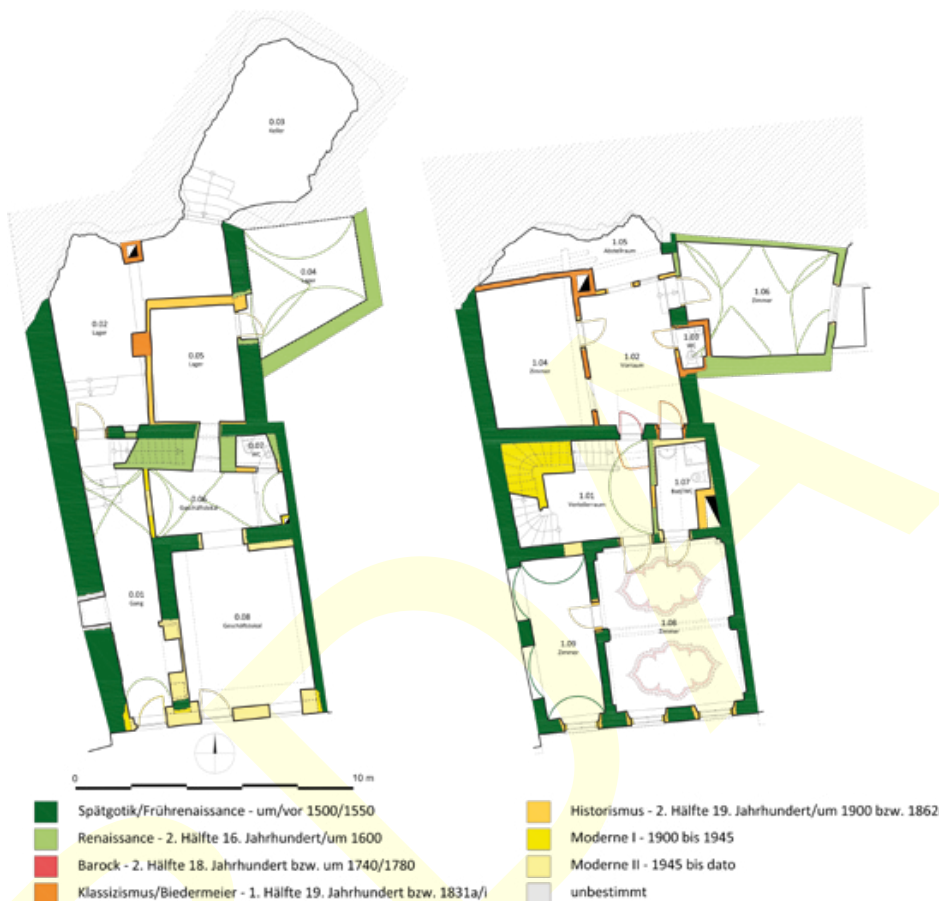
Abb. 10 Krems, Bürgerhaus Untere Landstraße Nr. 13. Baualterplan des Erdgeschoßes (links) und des 1. Obergeschoßes (rechts).
