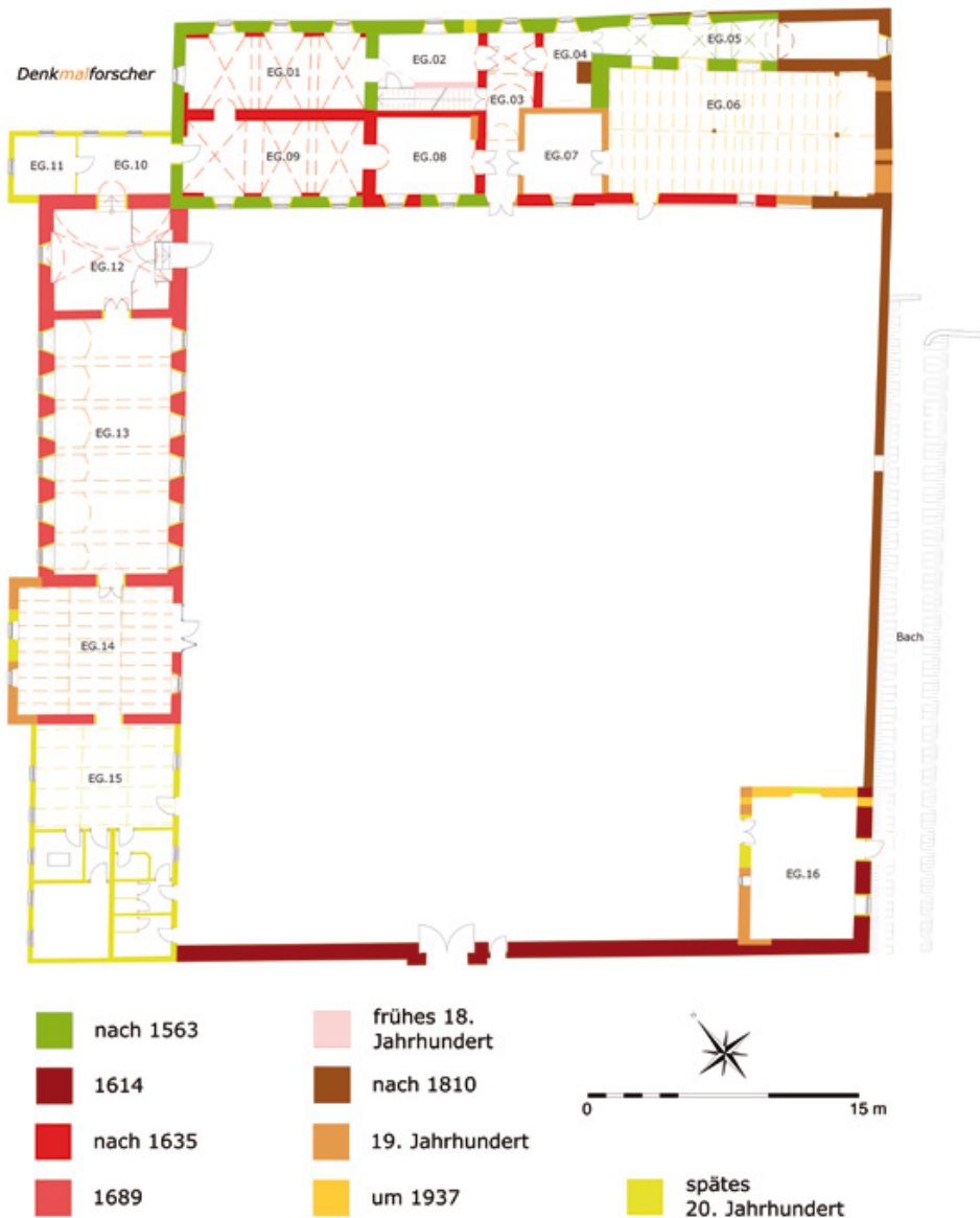
Abb. 7 Hollabrunn, Alte Hofmühle. Baualterplan des Erdgeschoßes.
