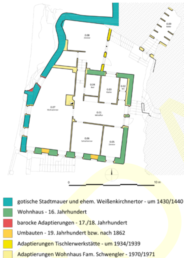
Abb. 2 Dürnstein, ehemaliges Weißenkirchner Tor. Baualterplan des Erdgeschoßes.
