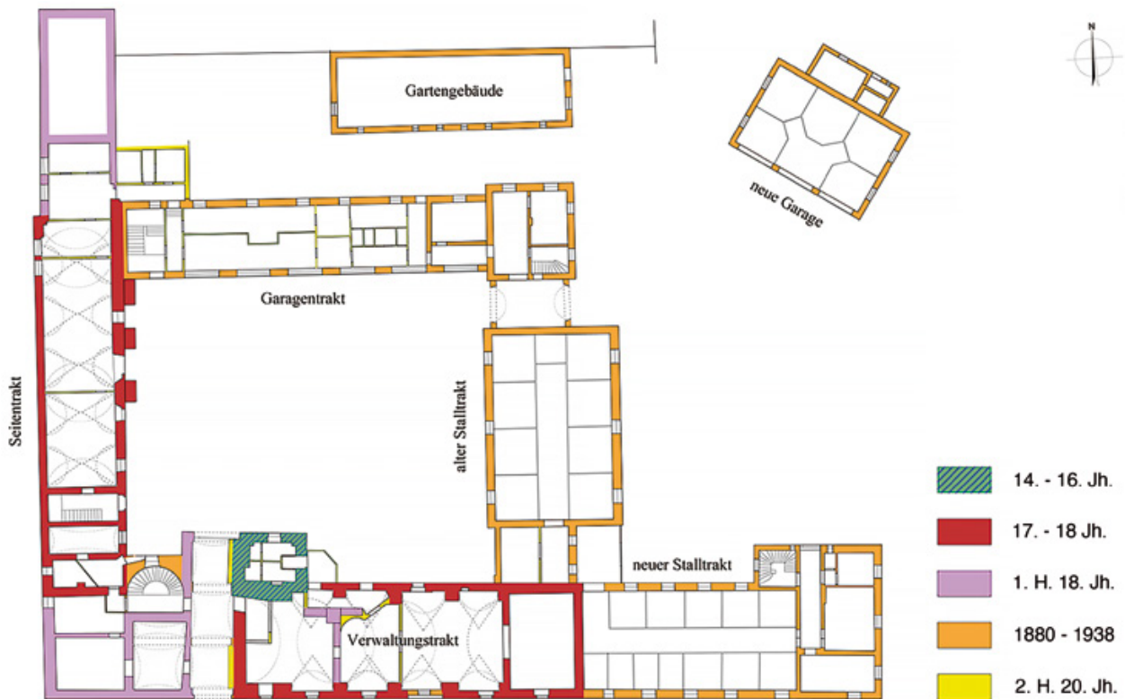
Abb. 4 Enzesfeld, Meiereihof. Baualterplan des Erdgeschoßes.
