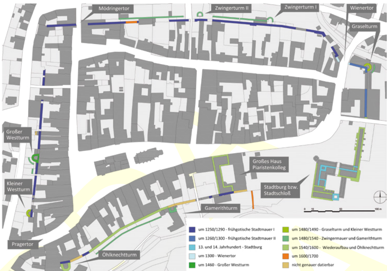
Abb. 8 Horn, Stadtbefestigung. Baualterplan der Gesamtanlage.
