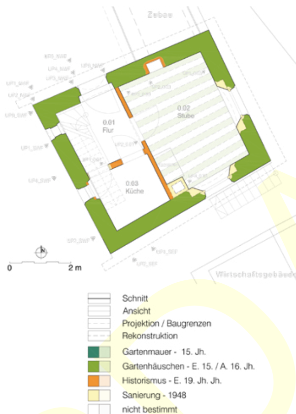
Abb. 2 Hötting, Gartenhaus des Ansitzes Lichtenturn. Baualterplan des Hauptgeschosses.
