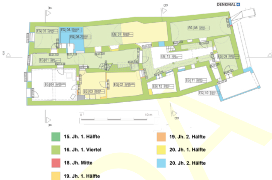
Abb. 4 Freistadt, Bürgerhaus. Baualterplan des Erdgeschoßes.
