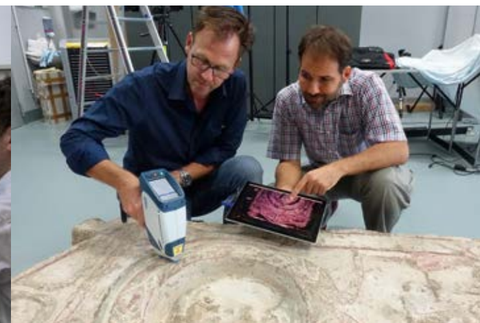
Die Röntgenfluoreszenzanalyse ermöglicht einen vollkommen zerstörungsfreien Nachweis von Pigmenten © ÖAI/ÖAW, Foto: Gabrielle Kremer
