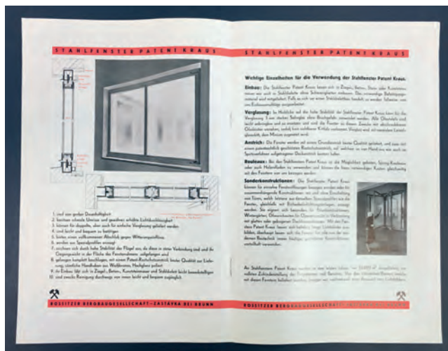
Abb. 3: Technische Informationen zum Kraus-Stahlfenster, Werbematerial der Rosická-Bergbaugesellschaft, 1932
