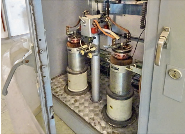
Abb. 5: Niederfrequenzstufe mit zwei Endröhren BTL 6-1
