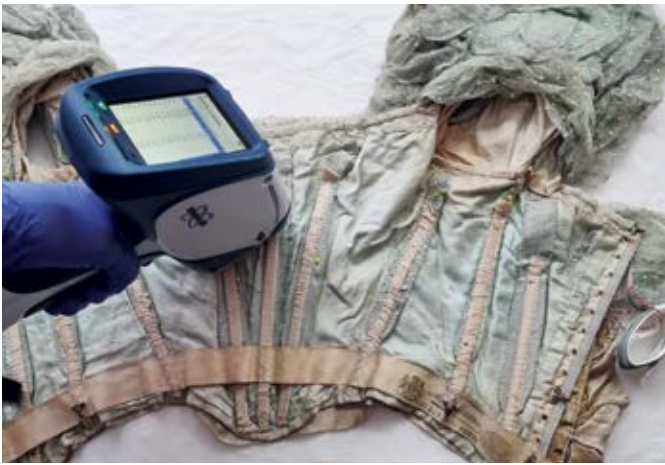
Die Röntgenfluoreszenzanalyse hilft, giftige Pigmente schnell zu identifizieren: Untersuchung eines Kleids von Kaiserin Elisabeth. © Regina Knaller
