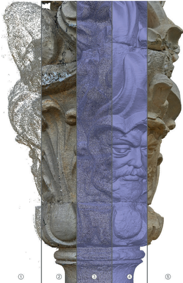
Abb. 3: Modellierungsschritte im „Structure from Motion-Verfahren“ zur digitalen Erfassung der Oberflächenstruktur von Kulturgütern (1: grobe Punktwolke; 2: dichte Punktwolke; 3: Drahtgittermodell; 4: Oberflächenmodell; 5: texturiertes Oberflächenmodell)
